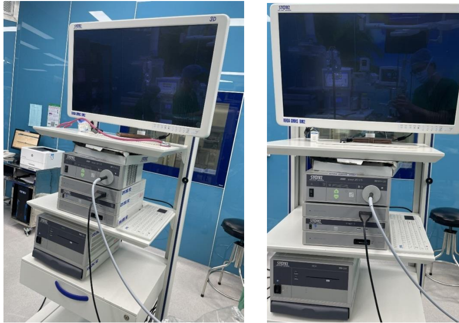
Hình 2.3. Dàn máy nội soi của hãng Kal-Storz
