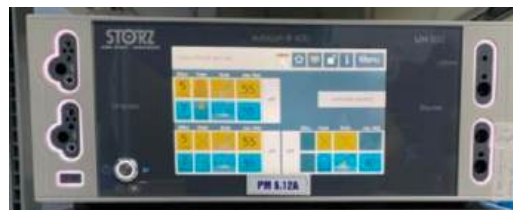
Hình 2.5. Dao điện lưỡng cực AUTOCON III 400 (Karl-Storz).
